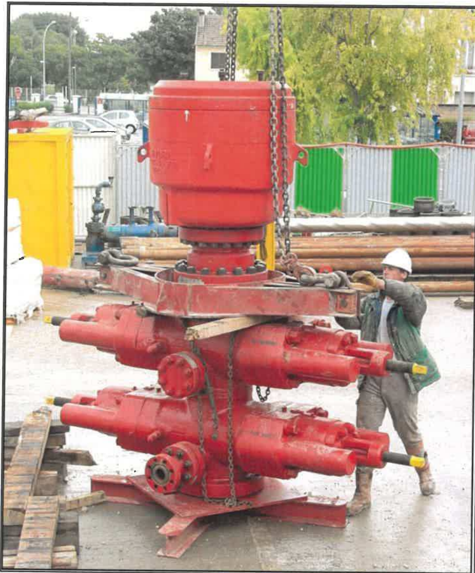
Figure 69 – Photo d'un BOP (Hydril) avant montage sur la tête de puits
