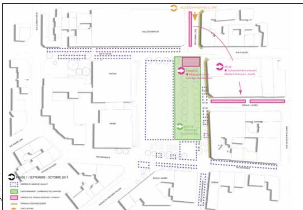
Voici un schéma de la première phase des travaux. Elle comprendra la construction d'un récupérateur d'eau de pluie, la démolition de la fontaine ainsi que l'enlèvement des toilettes extérieures.
