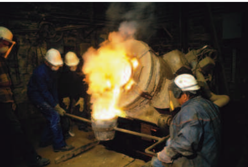
Quand l'alliage a atteint la bonne température, il est transvasé dans un creuset plus petit.
