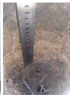
S1 : épaisseur du revêtement – épaisseur de l'enrobé – épaisseur de la couche de fondation
