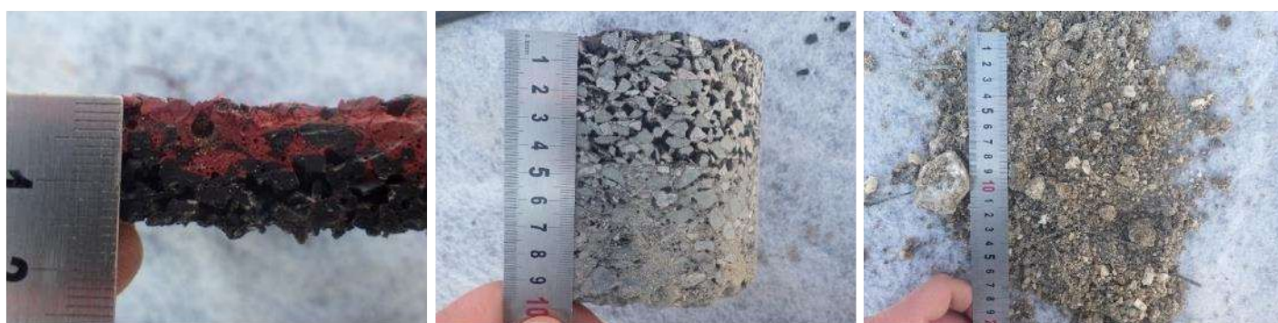
S4 : épaisseur du revêtement – épaisseur de l'enrobé – aspect de la grave
