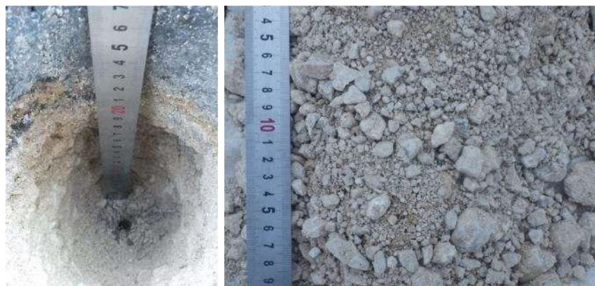
S2 : épaisseur de la couche de fondation – aspect de la grave
