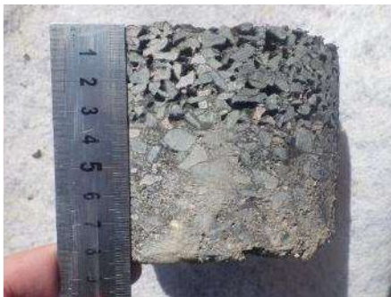
S1 : épaisseur du revêtement – épaisseur de l'enrobé – épaisseur de la couche de fondation
