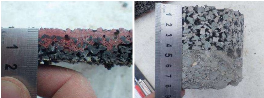
S2 : épaisseur du revêtement – épaisseur de l'enrobé
