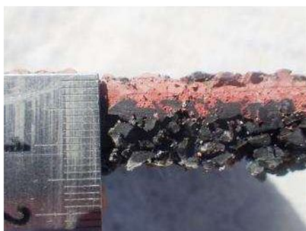
S1 : épaisseur du revêtement – épaisseur de l'enrobé – épaisseur de la couche de fondation
