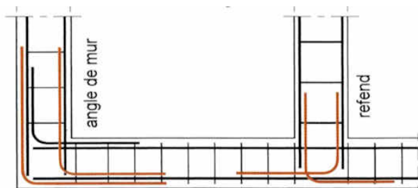
Figure 15 : vue en plan - armatures continues et continuité aux angles par des équerres
